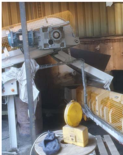
Figura 11. Foco 6: caída de piezas entre cintas
